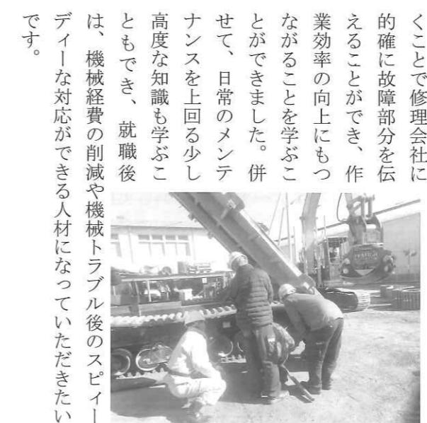
3日目は、プロセッサのアタッチメント部における油圧ホースの製作と交換作業を行いました。また、フォワーダのゴムクローラーの交換作業の実感することができました。
