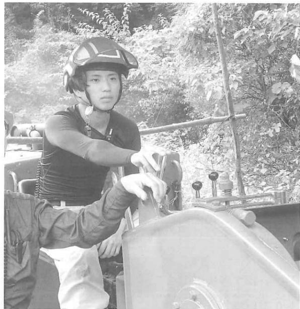
架設後は、問題なく作動するかの点検を行います。学科講習で学んだ振動波による主索緊張度の検定や安全係数、主要機器の据え付け方法も再度確認しました。その後、試運転を行い、安全に運転できることを確認しました。
