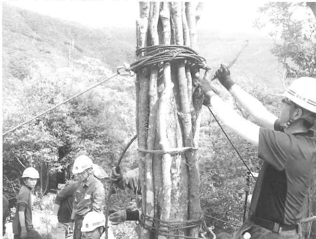
➤先柱にて当て木をした先柱に取り付けたサドルブロックにスカイラインを通してあります。
